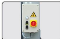
Panel sterowania napięciem bezpiecznym z wyłącznikiem awaryjnym
